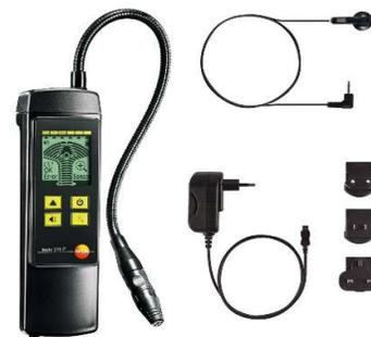
Optischer und akustischer Alarm durch Balkenanzeige bei zunehmenden und gefährlichen Gaskonzentrationen
